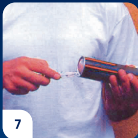
7 Perfore el cartucho antes de colocar la boquilla. Corte la boquilla a escuadra, dependiendo del diámetro de la tubería sobre la cual se va a trabajar y atornille en el cartucho (a mayor diámetro de tubería mayor debe ser el corte para facilitar la salida del producto). Monte el cartucho en la pistola aplicadora.
